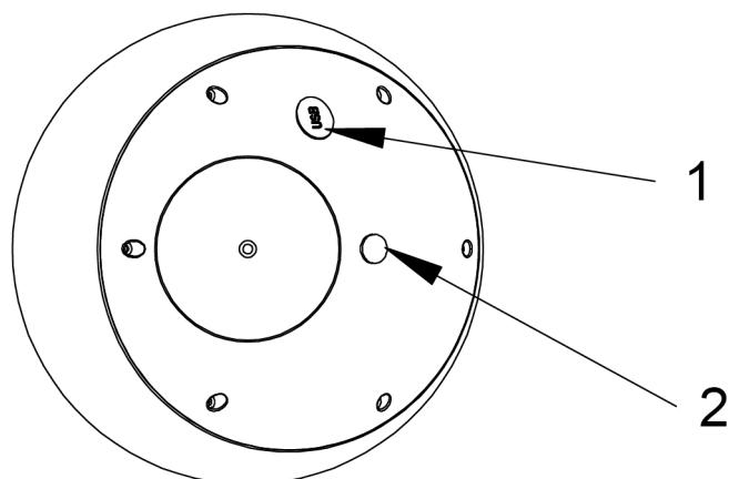
Schließen Sie das mitgelieferte USB-Kabel an einen Computer oder einen 5-V-Adapter an. Stecken Sie das MicroUSB-Ende des Kabels in den USB-Anschluss der Lampe(1). Nach 3 Stunden ist die Lampe vollständig aufgeladen.
