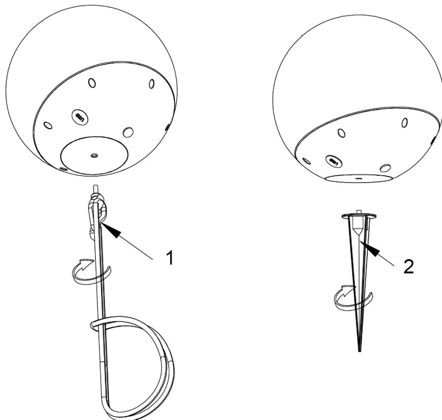
Utilisez la boucle de suspension (1) pour suspendre la lampe. Utilisez le piquet de terre (2) pour fixer la lampe dans le jardin.
