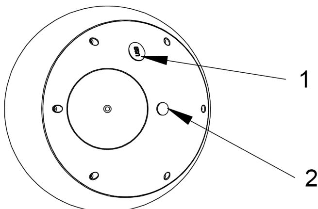
Conecta el cable USB suministrado a un ordenador o a un adaptador de 5V. Conecta el extremo MicroUSB del cable al puerto USB de la lámpara(1). Después de 3 horas la lámpara está completamente cargada.
