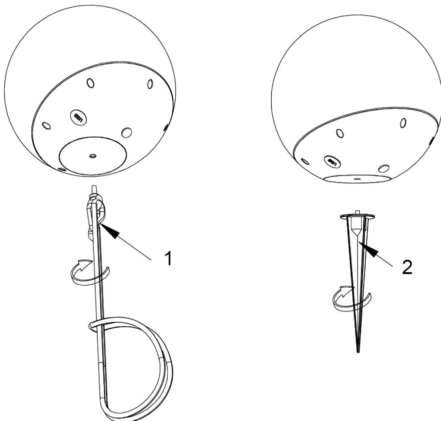
Utiliza el lazo para colgar (1) para colgar la lámpara. Utilice la estaca de tierra (2) para fijar la lámpara en el jardín.
