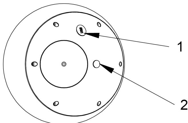
Sluit de meegeleverde USB-kabel aan op een computer of 5V-adapter. Steek het MicroUSB-uiteinde van de kabel in de USB-poort van de lamp(1). Na 3 uur is de lamp volledig opgeladen.
