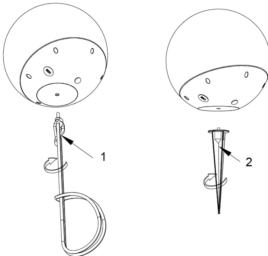
Verwenden Sie die Aufhängeschlaufe (1), um die Lampe aufzuhängen. Verwenden Sie den Erdspieß (2), um die Lampe im Garten zu befestigen.
