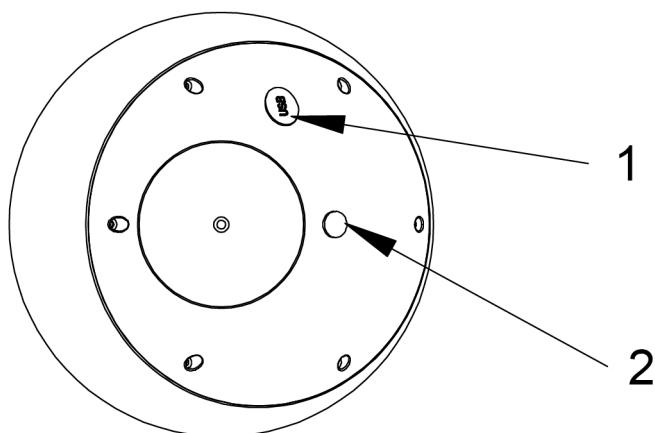
Podłącz dostarczony kabel USB do komputera lub zasilacza 5V. Podłącz końcówkę MicroUSB kabla do portu USB lampy(1). Po 3 godzinach lampa jest w pełni naładowana.
