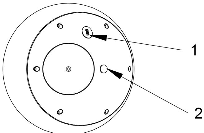
Connectez le câble USB fourni à un ordinateur ou à un adaptateur 5V. Branchez l'extrémité MicroUSB du câble dans le port USB de la lampe(1). Après 3 heures, la lampe est complètement chargée.
